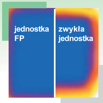
minimalne mostki cieplne
