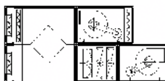
2. Pozioma z wentylatorem wywiewnym i nawiewnym
