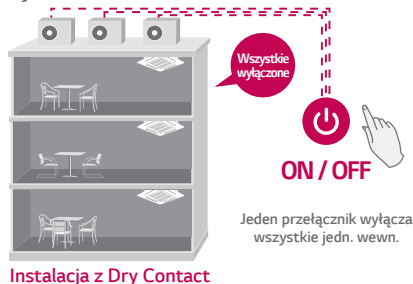
Instalacja z Dry Contact
